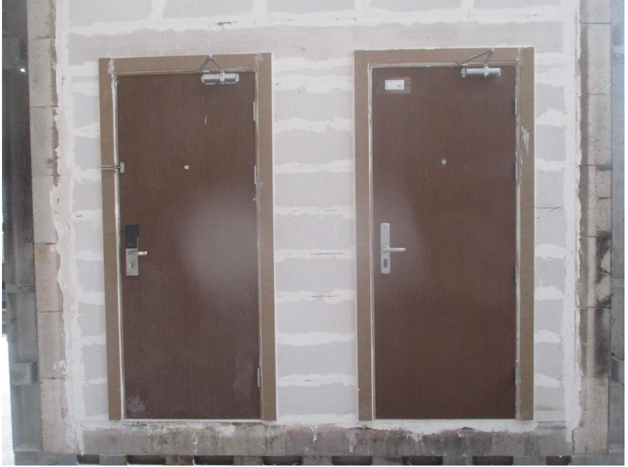
Fotoğraf C2: Her iki kapının aleve maruz kalan yüzeyinin test anındaki görünüşleri
