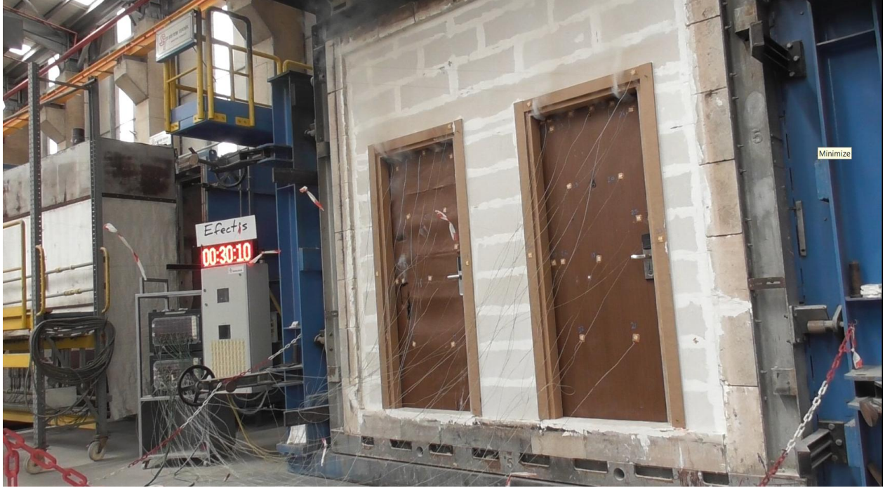
Fotoğraf C3: Her iki kapının aleve maruz kalmayan yüzeylerinin testin 30. dakikasındaki görünüşleri
