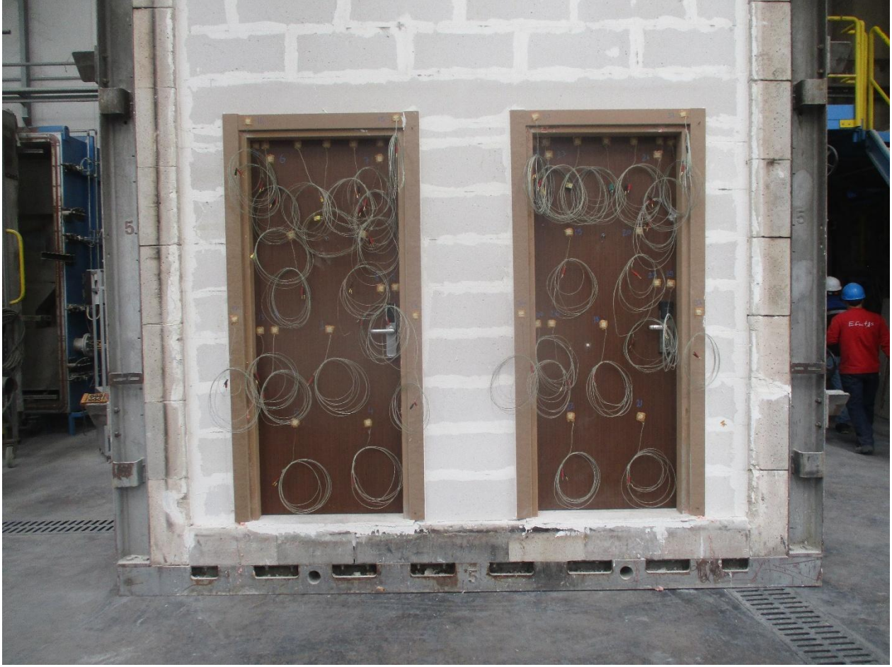
Fotoğraf C1: Her iki kapının aleve maruz kalmayan yüzeyinin test öncesi görünümü
